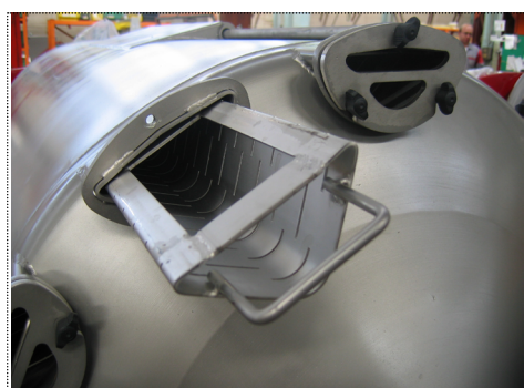
Extracción de las canaletas agujereadas
