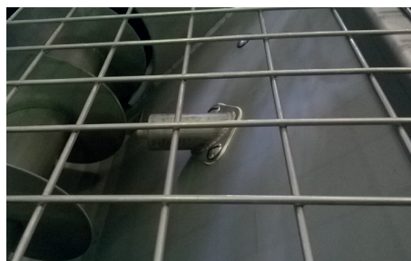
Sonda de detección del nivel (Opción)
